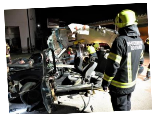
Technische Übung mit dem hydraulischen Rettungszyylinder zur Rettung eingeklemmter Personen
