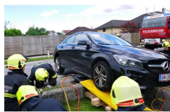
Aufsitzender PKW auf Gartenmauer — schonende Bergung mittels Hebekissen
