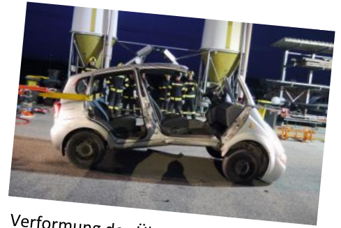
Verformung des Übungsautos im Zuge der Kettenrettung
